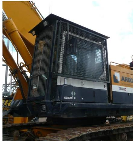
3. Risikobeurteilung erforderte Schutzmassnahmen: Nachrüstung eines Baggers mit Steinbrechergittern zum Schutz vor Querschlägeranprall
